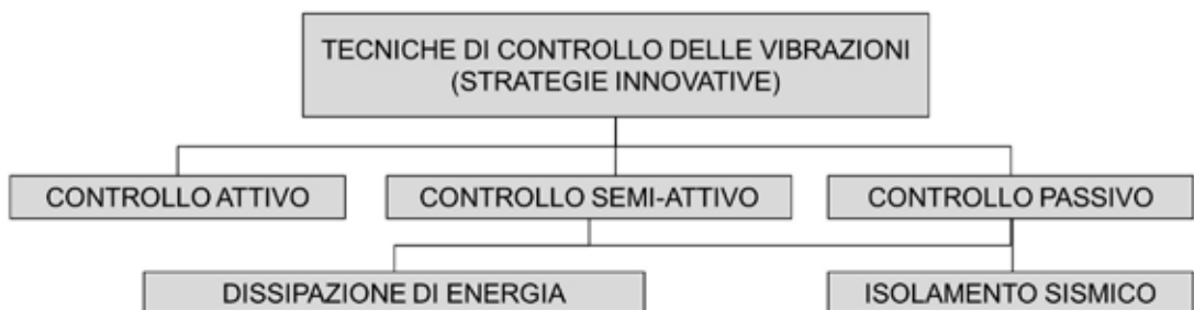
Figura 4. Schema di tutte le tecniche di controllo delle vibrazioni
