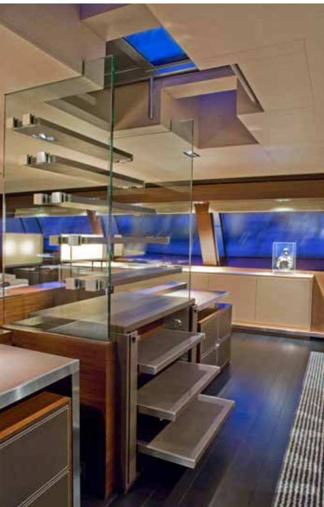
La scala di vetro strutturale con gradini di acciaio e cuoio, di collegamento con il flying bridge dello yacht Nirvana (Foto: Albert Brunsting)
